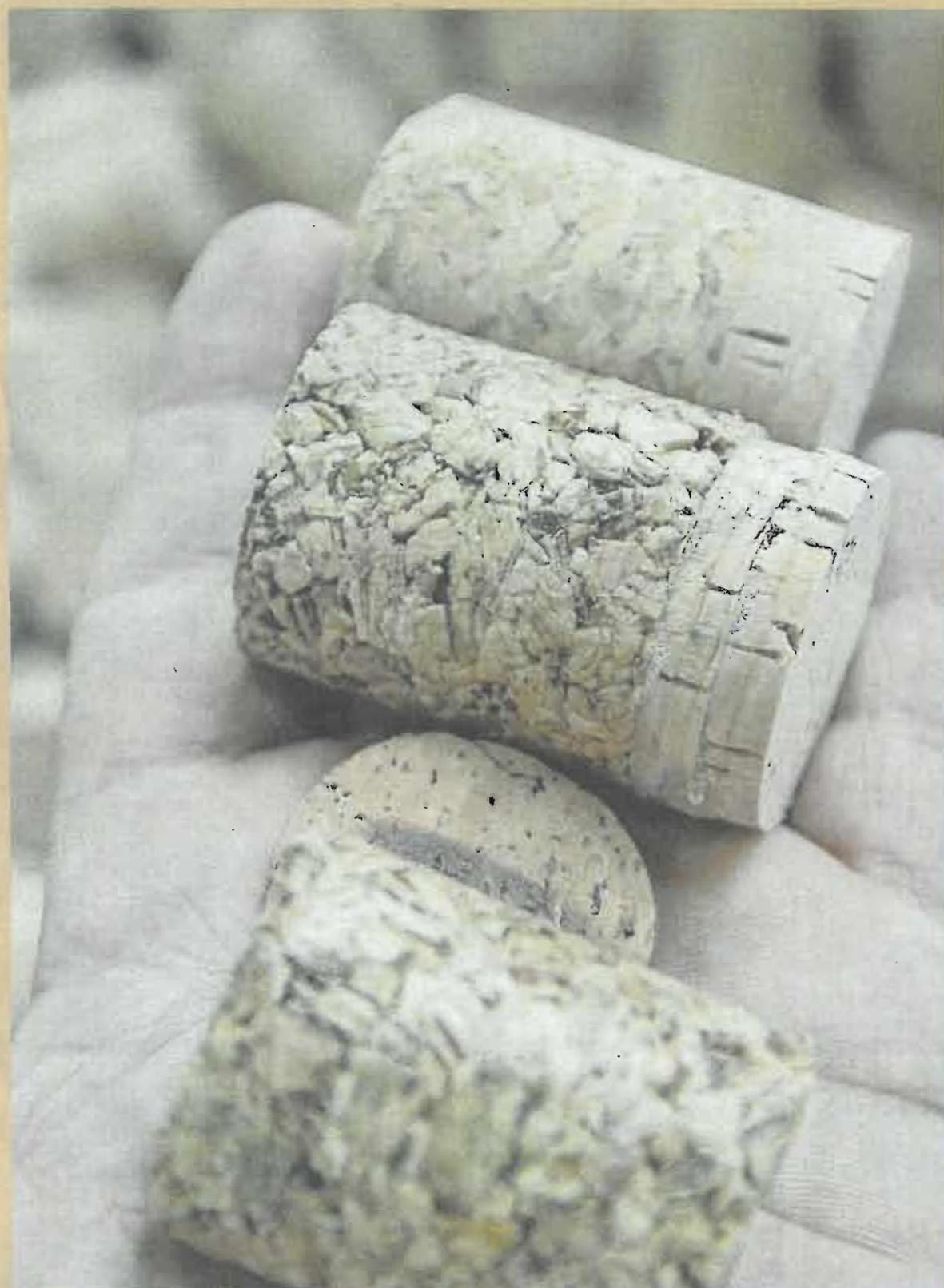
Le bouchon de champagne est différent des autres. Il est constitué d'un manche élaboré à partir de granules de liège (en bas de la photo) et de deux rondelles, côté vin, pour améliorer l'étanchéité (version finale en haut de la photo). Claire Hohweyer
