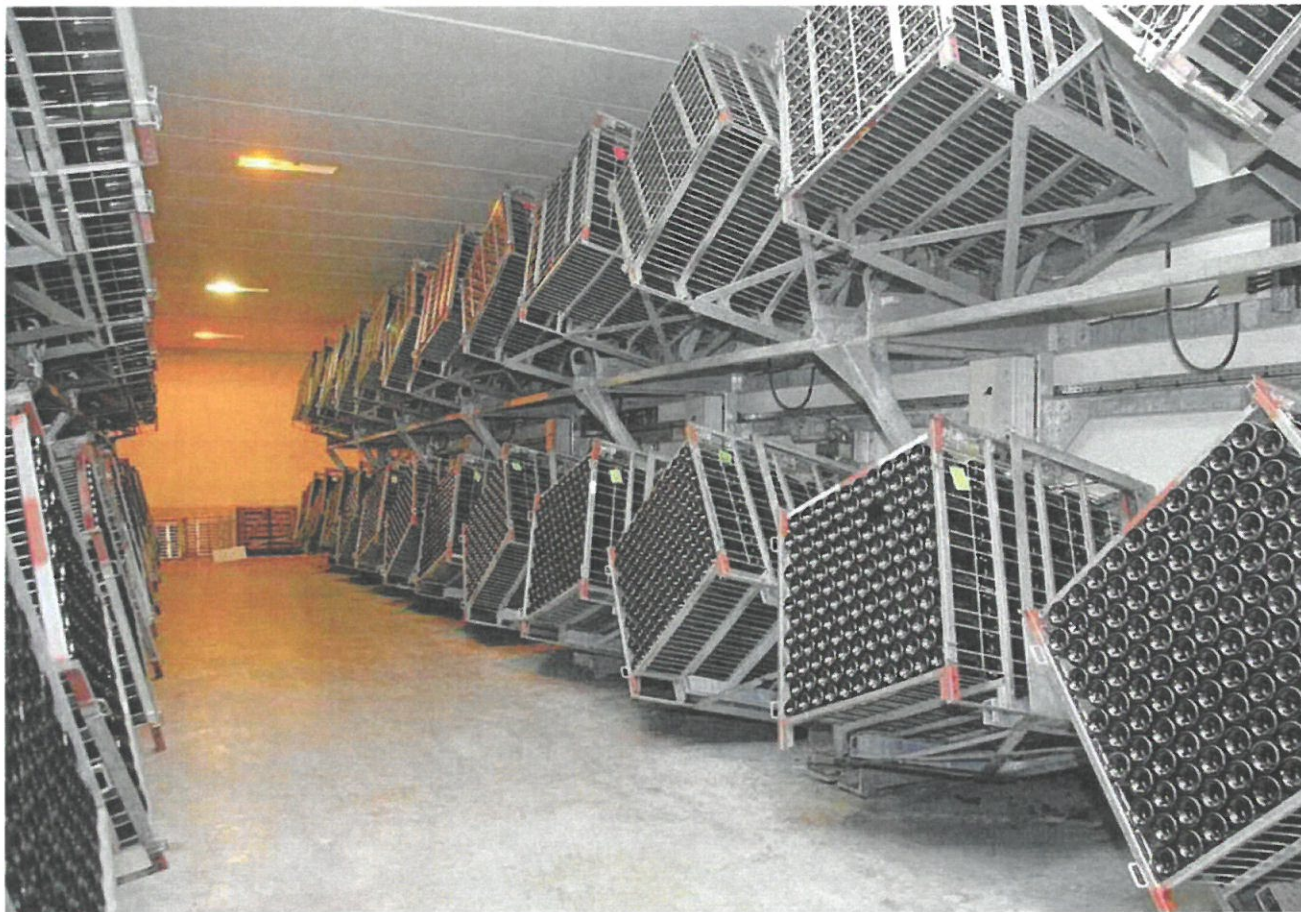
À l'étape de la seconde fermentation des vins mousseux, les bouteilles sont placées dans des caisses de remuage automatique.
