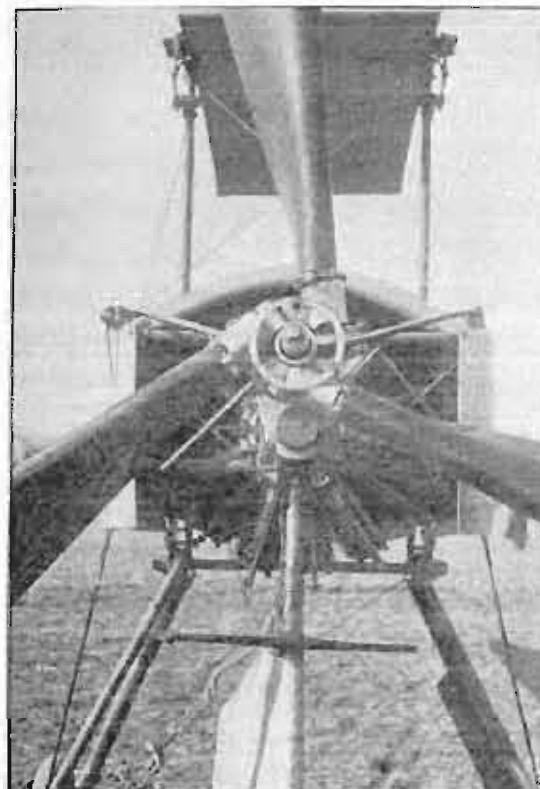
On distingue sur cette photo le réducteur du Breguet-Gnome militaire 1912. (L'illustration).
