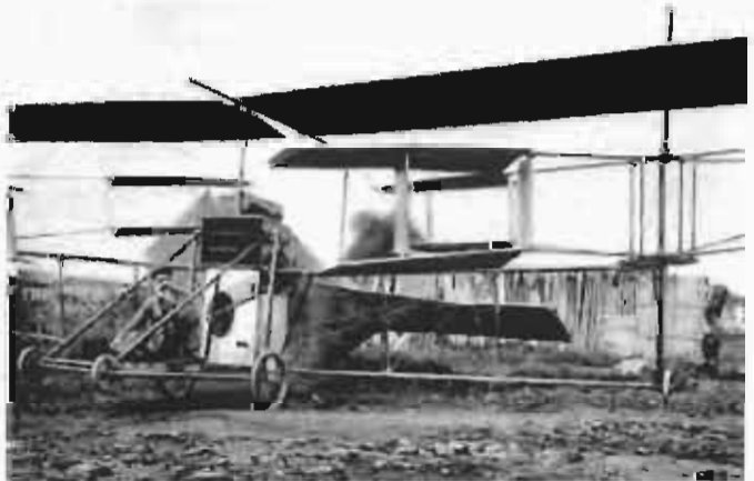
Encadrés par une voilure à deux plans à incidence variable, les deux voilures tournantes de 8 m de diamètre sont inclinées à 20 % de la verticale. Louis Breguet est assis aux commandes. (Archives de l'Aéro-Club de France).
