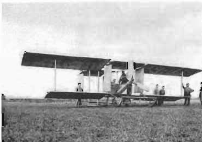
Breguet I avant un vol, 1909. L'hélice tripale est à pas variable en vol automatique. (Archives de l'Aéro-Club de France).
