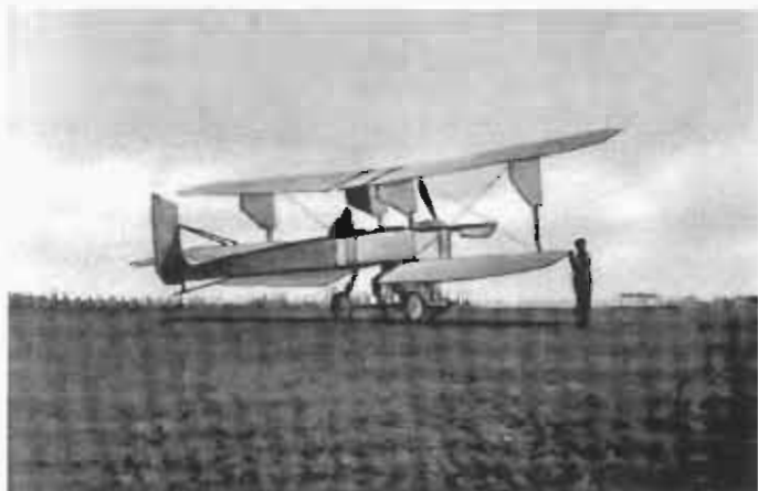
Breguet type III au sol, 1910. Son hélice est métallique à réducteur. (Archives de l'Aéro-Club de France).
