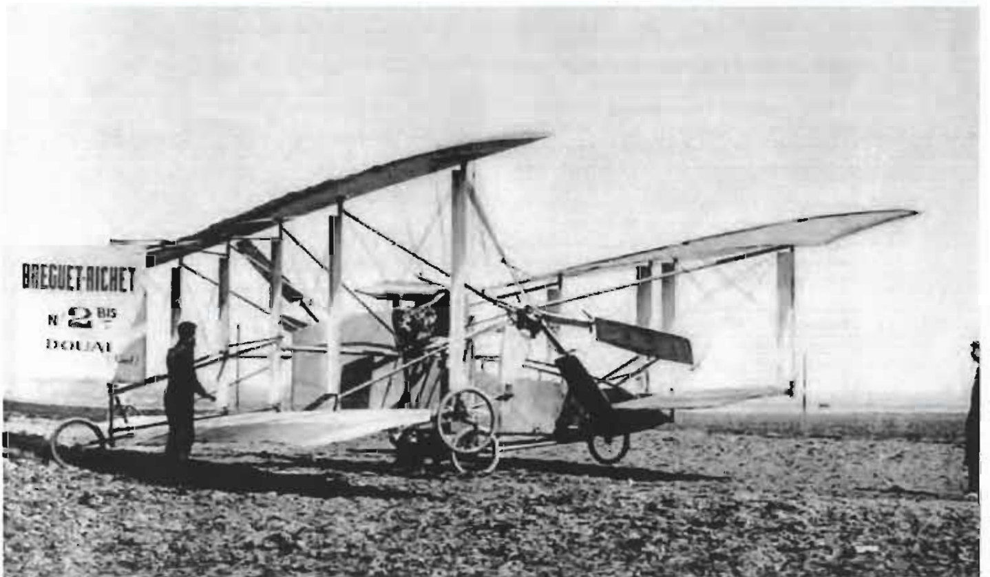
Le Breguet-Richet n° 2bis à décollage vertical « convertible » en vol horizontal est un biplan à aile pivotante (axe situé au bord d'attaque) doté d'hélices mobiles dans le plan vertical (1908). (Archives de l'Aéro-Club de France).
