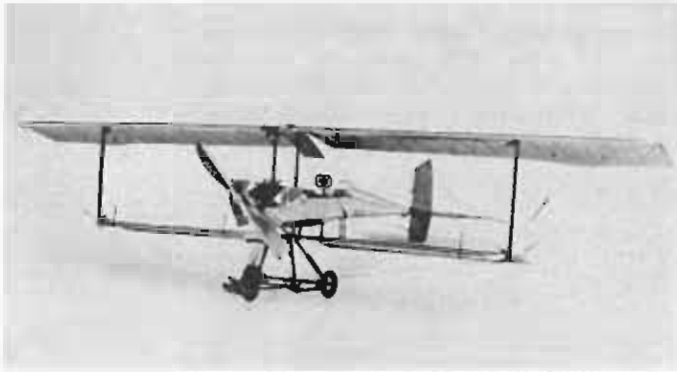
Le premier Breguet militaire : le triplace type II de 1911, propulsé par un moteur VB Renault de 60 ch. (Musée de l'Air).
