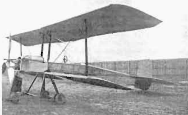
Le Breguet III à train tricycle amorti, hélice tripale métallique Breguet à réducteur et moteur rotatif Gnome 50 ch (octobre 1909). (Musée de l'Air).
